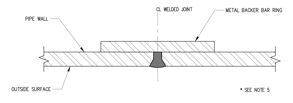
ALTERNATE CJP **TUBULAR BUTT JOINT** 2 SCALE: 1:1 —
